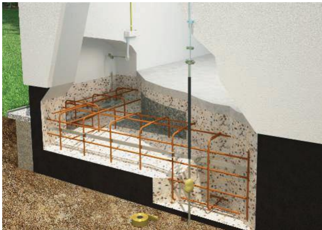
شکل (۱۱): الکتروود مدفون در بتن
