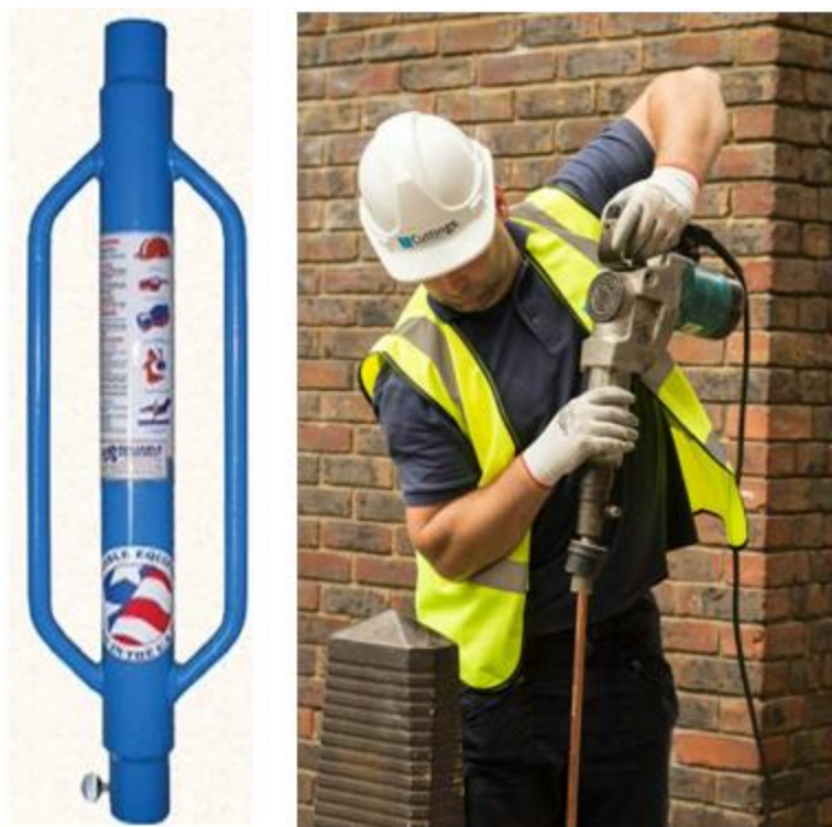
شکل (۴) : دو نمونه چکش مخصوص کوبیدن میله (سمت راست چکش برقی ، سمت چپ چکش دستی)
